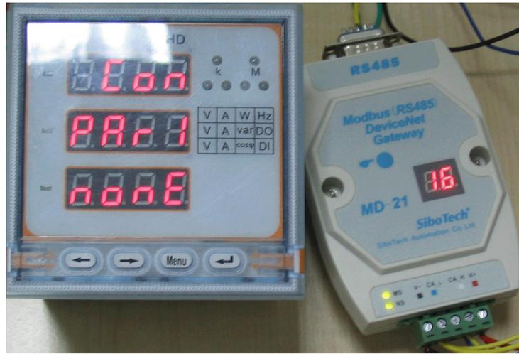
图 11 适配器与 PLC、仪表的硬件连接
