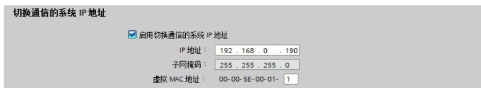
图 8 切换通信系统 IP 地址
