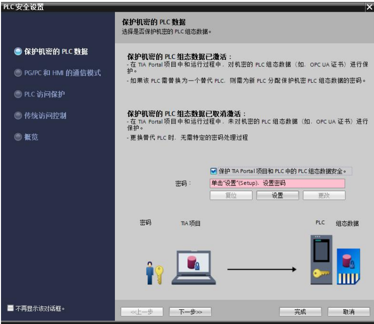
图 3 修改 PLC 安全设置
