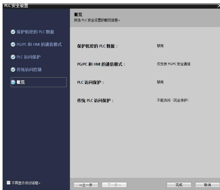
图 5 修改 PLC 安全概览
