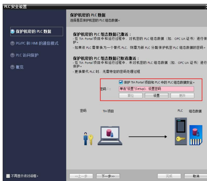
图 3 修改 PLC 安全设置
